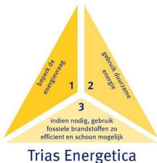
Figuur H1-01. Principes Trias Energetica internationaal geïntroduceerd door Lysen E. (1996) Nederlandse Onderneming voor Energie en Milieu
